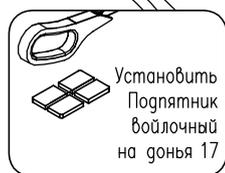
Две пластины разрезать на 4 части
